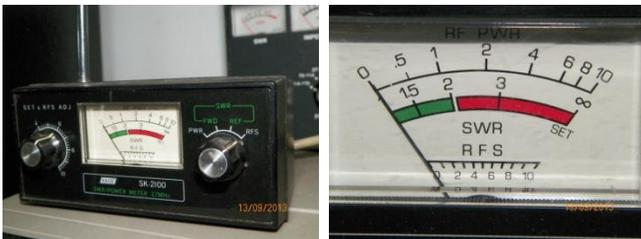
La mayoría de roímetros que tienen una antenita y posición RFS en el selector, **pueden medir presencia de señal de radiofrecuencia ( RFS )** y muchos Colegas no lo saben. Estos **carecen de selectividad** y por ende miden RFS en un amplio espectro de frecuencias ( HF, VHF y UHF ). No requieren conectar a nada, solo hay que aproximarlos al dispositivo que esté irradiando RF, e indicará su intensidad en un galvanómetro
