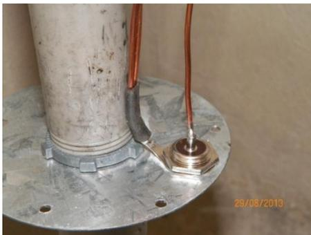
En la anterior imagen inferior derecha se observa el conjunto principal de la base de antena, ya con el conector para cable coaxial y seis tubos cortos ( Para introducir telescópicamente los radiales ). Solo una de las tapas circulares para cajetín eléctrico queda fijada entre la tuerca y el anillo conduit de 1 pulgada ( Fotografías de la fila central ).
