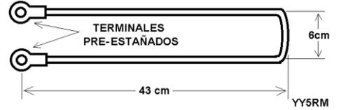
El stub de la imagen anterior permite **mayor rigidez y menor tamaño del arreglo colineal**, para sintonizar solo hay que alargar o recortar su longitud ( Menos de 43 cm para Frecuencias mayores de 146 MHz y mayor de 43 cm a la inversa ). Es posible construirlo en aluminio o
