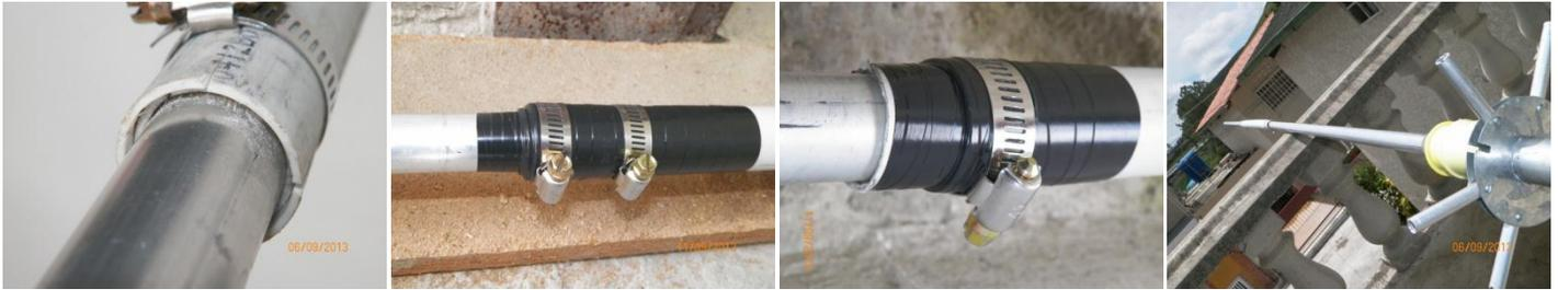
Repetir el procedimiento para enfasar el(los) tramo(s) siguiente(s). Dependiendo de los materiales empleados y resistencia al viento, es posible enfasar cuatro tramos. En los experimentos logre instalar el cuarto tramo solo con el fin de comprobar rigidez ( Excesiva longitud física, observar fotografía panorámica ):
