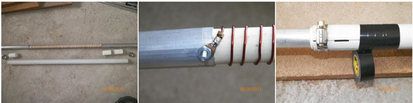
Soldar un terminal pre-estañado en un extremo del alambre de cobre esmaltado, conectar al tubo de aluminio por medio del tornillo con tuerca y arandela antivuelatas, enrollar aproximadamente 80 espiras uniformemente separadas ( En el tubo PVC ) y conectar de igual forma en el extremo final de la bobina ( Comprobar continuidad ).
