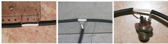
En los extremos de L1 deben cortocircuitarse las mallas con los conductores centrales y empalmar con los tramos siguientes ( L2 ).
