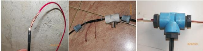
Dos aisladores para los extremos de la antena. Se usaron niples ( Caños ) de tubo PVC, de 1/2 pulgada de diámetro, por 15 ó 20 centímetros de largo, con orificios para insertar alambres.
