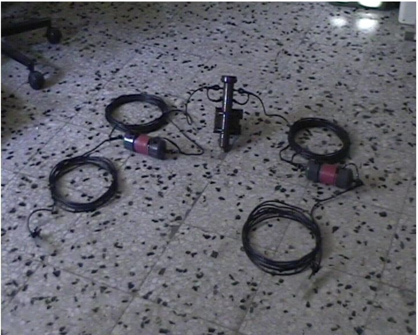
Fig 5: Conjunto de antena sin la protección final de las trampas
