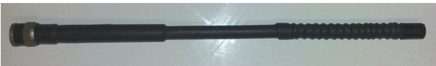
La ganancia de la antena en UHF es similar a 1/4 de onda, mientras que en VHF si bien es algo menor a eso, por el efecto de las bobinas, de todas maneras supera ampliamente a una colita de chanco.
