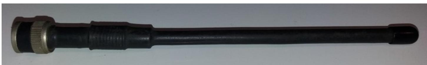
La antena de la foto, una vez ajustada, resultó tener un rendimiento levemente superior a la antena original provista en un Handy Yaesu FT 23R.
