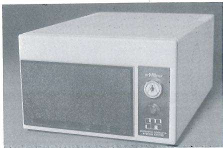
Foto 10. Subsistema de disco duro SYMBFILE (de 5 Mbytes) para los ordenadores APPLE II y RANK XEROX 820.
