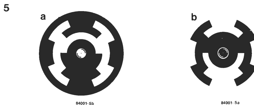
Figura 5. Disco codificador. La parte representada en negro es opaca. La mejor solución consiste en tomar un trozo de circuito impreso y cortar el disco respetando el modelo. El modelo 5a es adecuado para un montaje con sensores reflectores y el 5b para cuando se utilizan LEDs con fototransistores.
