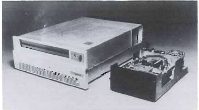
Fotografía 1. A la derecha, un lector de disquetes; a la izquierda, el sistema de discos ópticos OPTIMEM de Shugart, cuyo prototipo fue presentado a finales de 1983 en los Estados Unidos. Costará unos 6.000 dólares (sin incluir el controlador).
