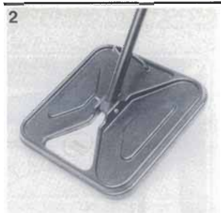
Fotografía 2. Esta es sin lugar a dudas la parte más importante del detector de metales: la bobina de exploración.
