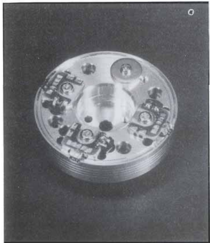
Figura 4. Fotografía de un tambor de cabezas típico, con un diámetro de tan solo 40 mm, conteniendo las dos cabezas de grabación/reproducción y una de borrado.
