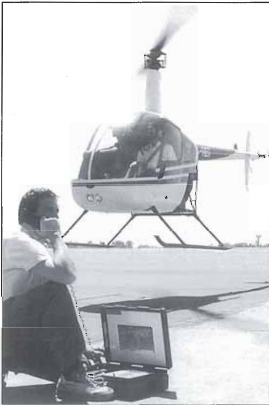
El Inmarsat-M permite el envío de datos y fax, además de las comunicaciones de voz.
