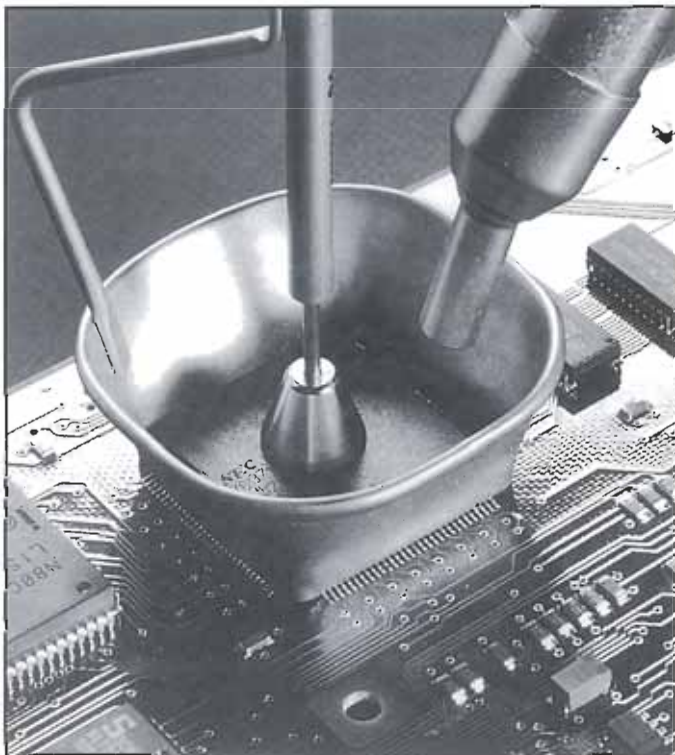
La estación JT 6040 está especialmente diseñada para la desoldadura de CI tipo Flat Pack.
