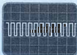
(c) Forma de onda de prueba-c. Se ha eliminado la frecuencia de la señal portadora.
