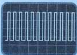
(e) Forma de onda en el punto de prueba-e. Se invierte la señal y pasa al decodificador
