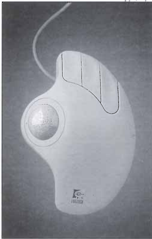
En el TrackMan Marble se sustituyen los componentes mecánicos por componentes opto-electrónicos.
