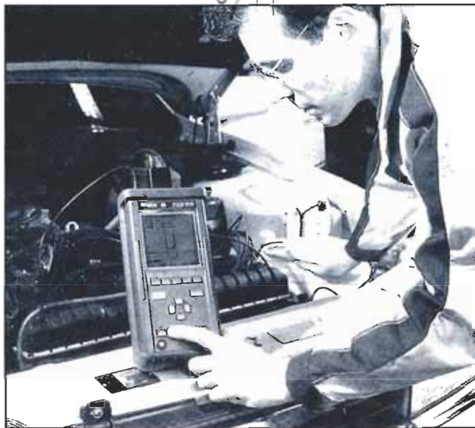
El PMS 100 permite controlar de forma rápida y fácil la electrónica de vehículos.
