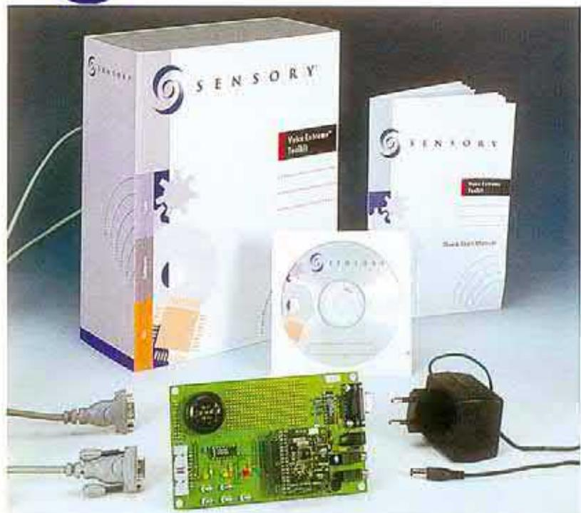
tipo "header" de 34 terminales. Para su uso en producción, el módulo "Voz Extrema" está disponible en un paquete "QFD" o en elementos separados. Este paquete también soporta la reprogramación sobre el propio circuito.
