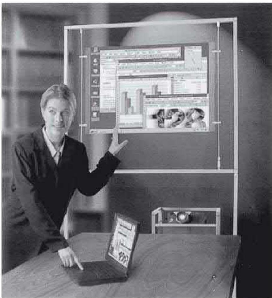
La pantalla está construida a partir de un material especial llamado Photopolymer, el cual es capaz de reflejar la luz. Esta pantalla polariza la imagen del proyector, el cual proyecta en un
