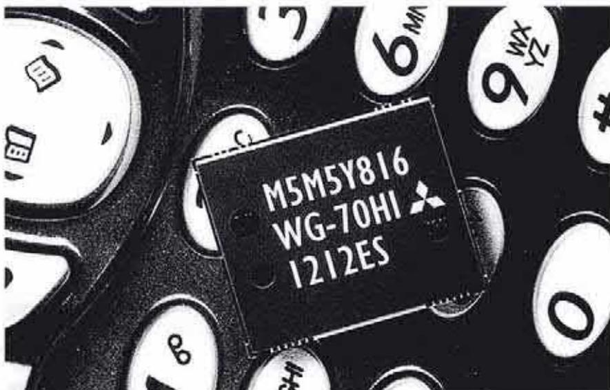
ambiente de 25 °C. Los SRAM de baja potencia posibilitan tiempos de acceso de 70 ns y operan en todo el rango de temperatura industrial (-40 a +85 °C) para incrementar la durabilidad.
