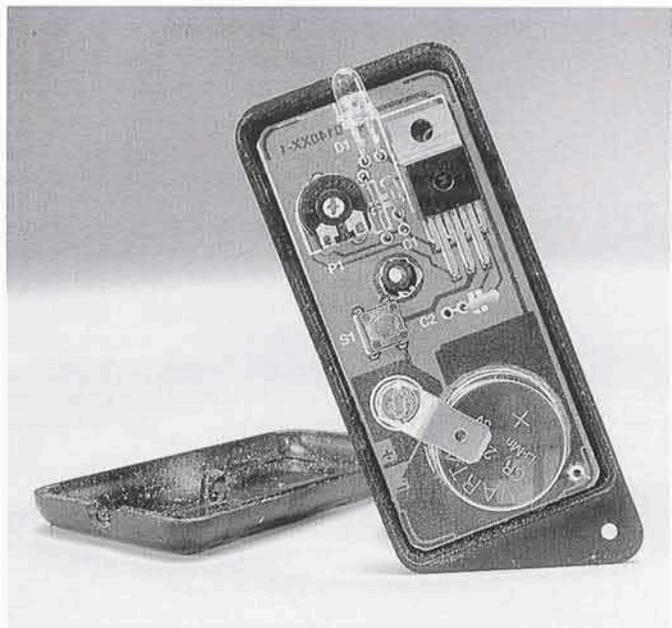
Una mini linterna de bolsillo combina las ventajas de las pilas de botón de Litio con un LED blanco super-brillante. Las pilas de Litio son pequeñas, tienen una larga vida y tienen muy poca descarga. El LED tiene una muy alta eficiencia, una larga vida y un consumo muy pequeño (20 mA). La combinación de estos resultados da lugar a una linterna de bolsillo de larga duración.
