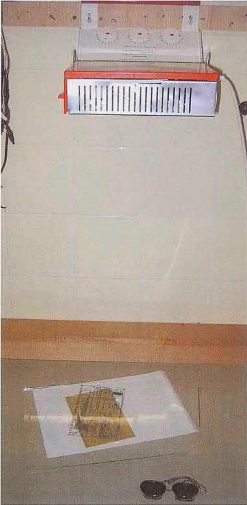
Figura 2. En el proceso de exposición se puede utilizar una lámpara solar tradicional.
