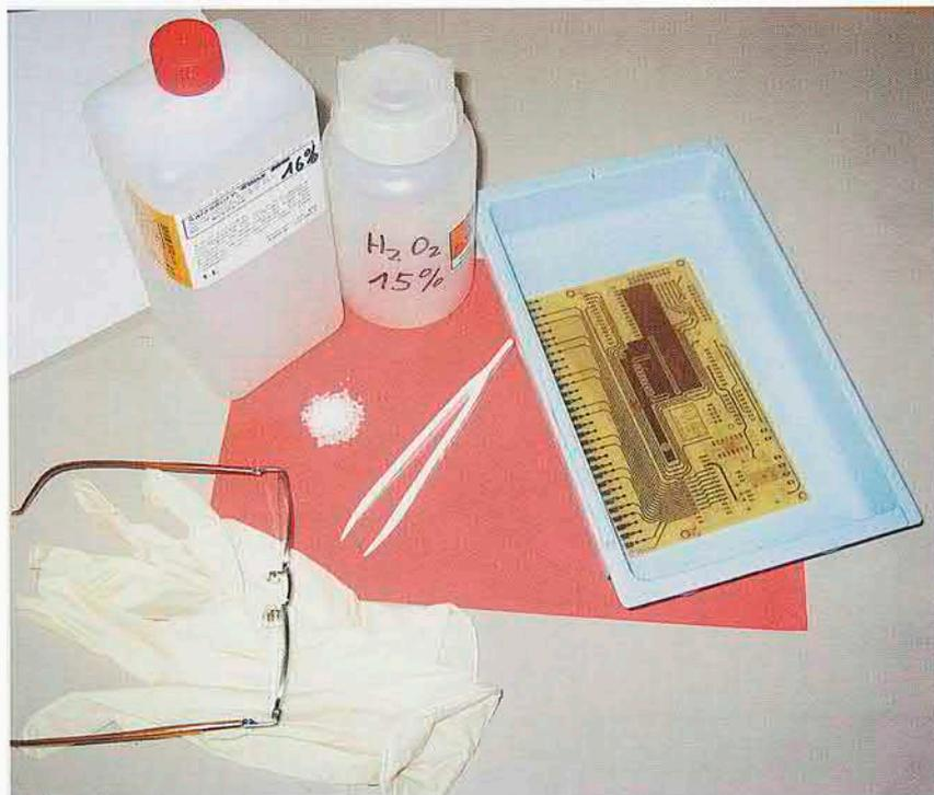
Figura 3. Equipamiento necesarios para el tratamiento con ácido.
