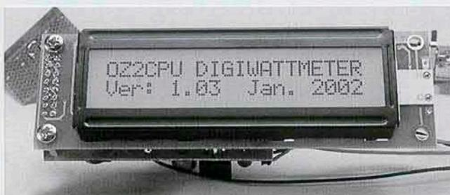
La pantalla principal de inicio nos muestra las medidas: dBm, estado, barra gráfica del nivel de RF, los vatios de potencia de RF medidos.
