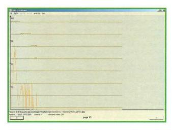
Figura 30. La aplicación LogView GBPLC puede usarse para mostrar y exportar datos de control recogidos por la PLC.
