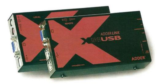
Permiten separar hasta cien metros de distancia de un ordenador un teclado, ratón, monitor y hasta cuatro dispositivos USB utilizando un solo cable CAT6.
