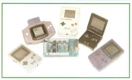
Figura 1. Modelos de consolas GameBoy válidas. La unidad del centro es la "Caja de E/S para GBPLC con Interfaz 12C", la cual controla la consola GameBoy equipada con un módulo GBPLC.
