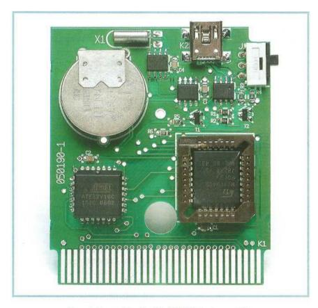
Figura 4. Placa prototipo del módulo GBPLC totalmente ensamblada.
