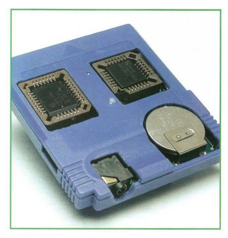
Figura 7. Módulo GBPLC ya acabado y montado en el encapsulado de un cartucho de juegos para la GameBoy de reserva. En esta imagen de un prototipo, se ha utilizado un zócalo para el circuito integrado IC2, y un conector tipo "jack" hembra para K2. El módulo totalmente ensamblado, que también está disponible para su venta a través de nuestro Servicio de Lectores, tiene el circuito integrado IC2 soldado a la placa y utiliza un conector mini-USB hembra para K2 (ver Figura 4).
