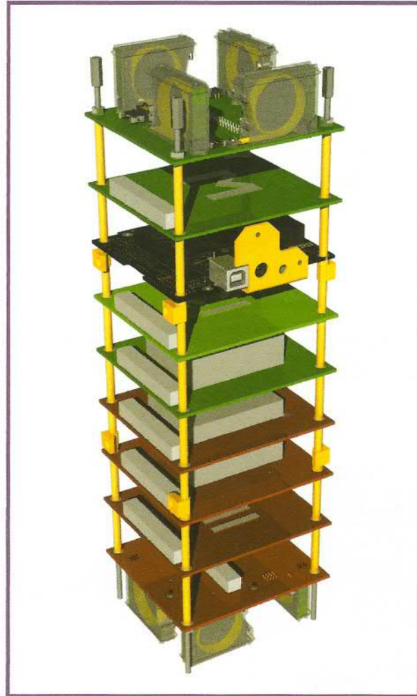
Las tres unidades del Delfi-C 3 están empaquetadas en forma de bocadillo con la electrónica, tal y como podemos ver en este dibujo CAD.
