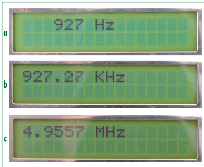
Figura 4. La lectura de la pantalla cambia automáticamente según la frecuencia entre Hz (a), kHz (b) y MHz (c).
