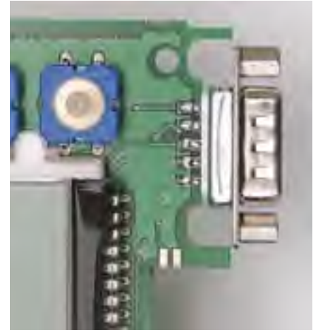
Figura 9. El conector Sub-D se suelda por ambas caras de la tarjeta.
