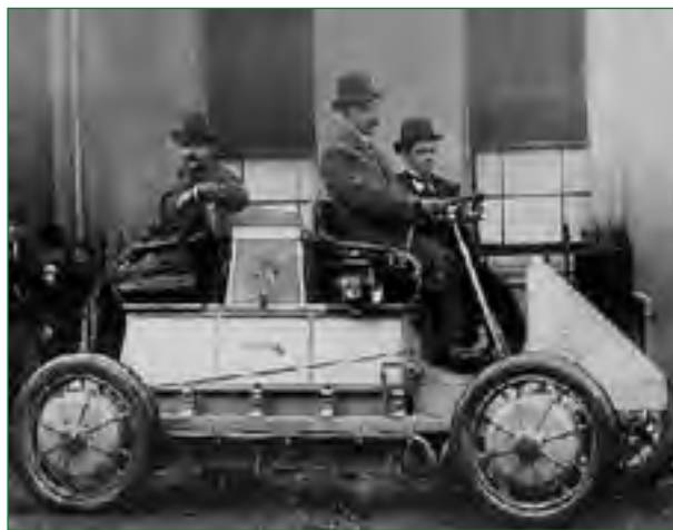
Figura 2. El Lohner-Porsche de 1900. Se trataba de un coche híbrido: un motor de gasolina obtenía mediante un generador de corriente continua la energía para un motor de tracción directa.
