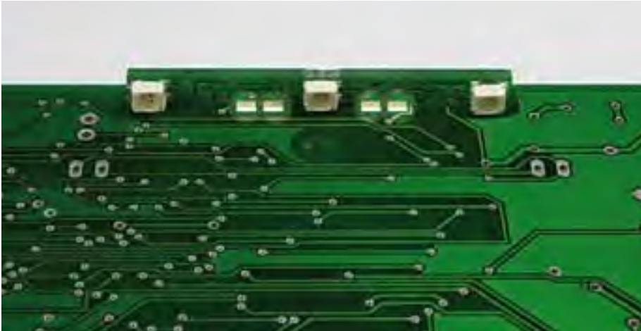
Figura 8. El montaje de los LED para la retroiluminación del display.
