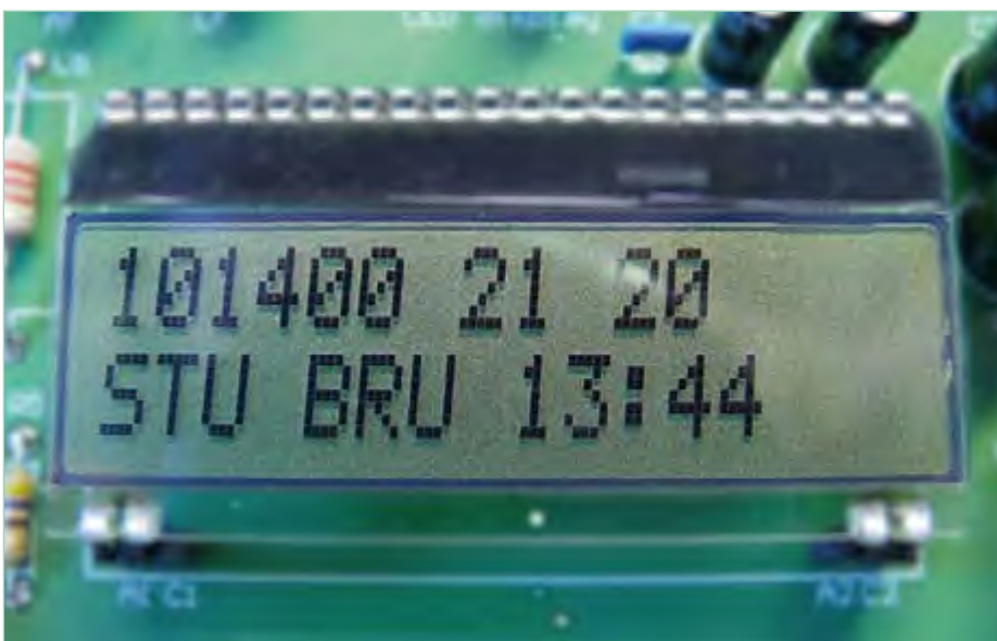
Figura 5. El display muestra la frecuencia actual, la tensión de la antena en dBµV y la relación señal/ruido (SNR en dB). En el modo FM, en la línea inferior también se muestra el nombre de la emisora y la hora transmitida mediante RDS.
