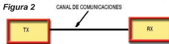
Tx = equipo transmisor y Rx = equipo receptor
