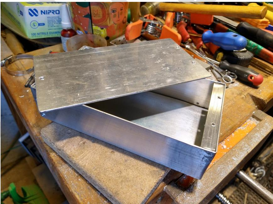
Gabinete perforado y pulido, listo para comenzar el montaje de los componentes:
