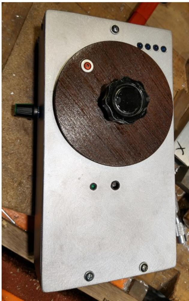
Los conectores externos de esta controladora están en la parte trasera del gabinete (no se ven en la foto), y son un jack de alimentación, y un jack RJ45 para el cableado que irá hacia el motor.
