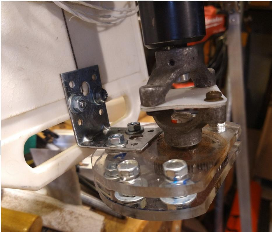
Primeras pruebas con un prototipo de control, parece que la reducción 6:1 es suficiente. El motor está marcado para 24 VDC, lo he probado con 5 a 6 VDC midiendo una corriente de 500 mA y con la reducción logra mover el capacitor sin perder pasos. Seguramente elevaré la tensión a unos 12V (por el tema de la caída de tensión del futuro cableado), pero esto es un tema secundario que lo veré al final de todo, según necesidad.
