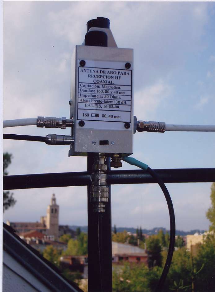
Figura N°3: Antena de aro recepción para 160, 80 y 40 metros. Detalle exterior de la caja de sintonía. En la parte superior tenemos, el mando de accionamiento manual del condensador variable C1 de 725 pF el cual, permite sintonizar las bandas de 80 y 40 metros dentro del mismo margen. Más abajo, los conectores F macho y hembra J1 y J2 correspondientes al aro de sintonía L1. En este orden y parcialmente, el bucle de acoplamiento L2 con el conector RCA macho y hembra J3 y terminal con borne J5. El conector BNC macho y hembra J4, de salida coaxial 50 Ohms hacia el receptor. Finalmente el conmutador deslizante I, que permite añadir una capacidad C2 de 1220 pF en paralelo con el condensador variable C1, para cubrir la banda de 160 metros. Obsérvese que el conector F lado derecho del aro de sintonía L1, está montado de forma aislada de masa mediante una pieza intermediaria de policarbonato.
