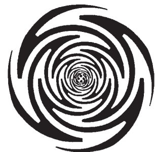
Fig. 7.22 Antena logoperiódica de cuatro brazos
