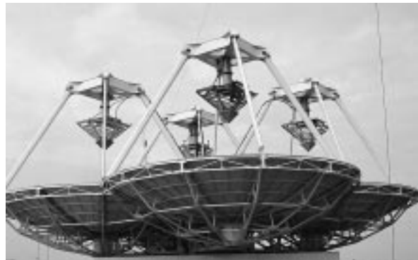
Fig. 7.21 Antenas logoperiódicas trapezoidales dobladas usadas como alimentadores de un reflector
