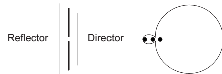
Fig. 5.38 Diagrama de radiación (campo) de una antena Yagi de tres elementos: activo de 0,475\lambda , reflector de 0,5\lambda y director de 0,45\lambda , espaciados 0,2\lambda
