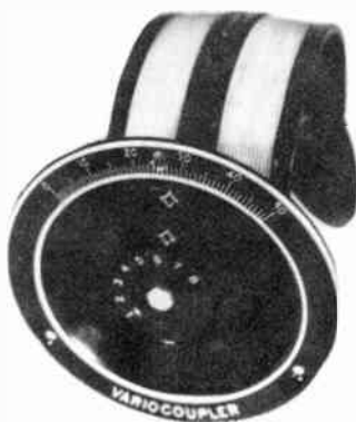
EISEMANN VARIO-COUPLER SWITCH POINTS INSIDE
