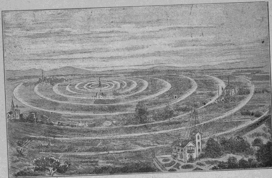
PROPAGACIÓN DE LAS ONDAS HERTZIANAS 1, Estación transmisora.—2, 3, 4 y 5, Estaciones receptoras
